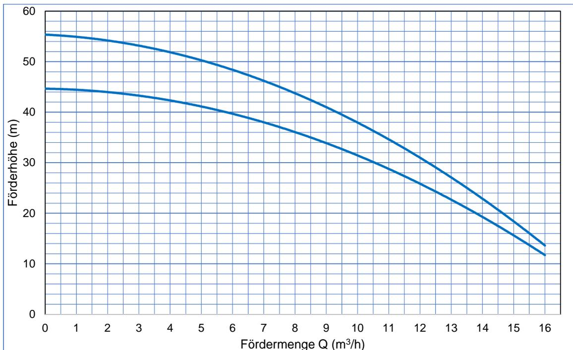
Diagramm 3.4.1.1 Q / H Diagramm iServer 16
