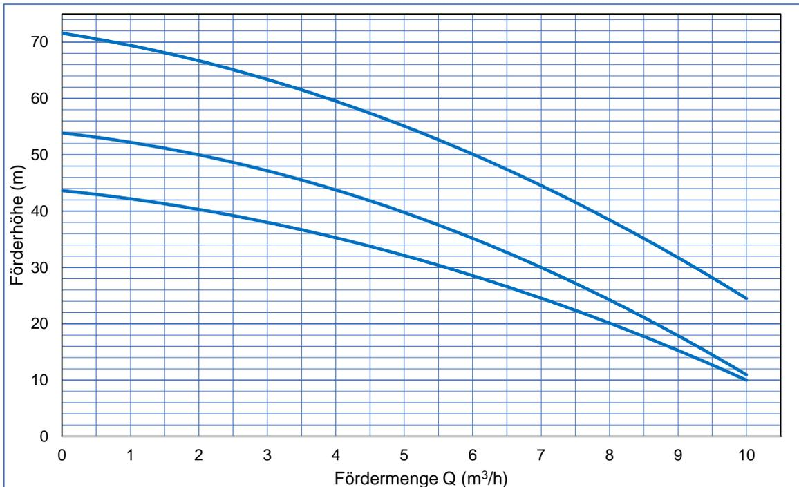
Diagramm 3.4.1.1 Q / H Diagramm iServer 10
