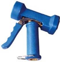
Profi Reinigungspistole für Trinkwasser mit einem Gehäuse aus Messing, einer Gummiummantelung (EPDM), einem Ventileinsatz aus Edelstahl und Dichtungen aus EPDM bzw. NBR. Die Reinigungspistole ist nach KTW D2 und DVGW W270 zugelassen. Die Spritzpistole ist für Reinigungsanwendungen in Industrie und Gewerbe, die eine Trinkwasserzulassung erfordern, geeignet.
