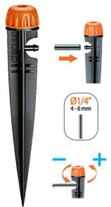
□ Tropfer montiert auf einem Erdspieß für eine gezielte Bewässerung der Pflanzenwurzeln. Das Tropfrohr 1/4" (4 – 6 mm) wird an den Anschluss unterhalb des Kopfes aufgesteckt und am anderen Ende mit einem 2-Wegeverbinder verbunden. An der gewünschten Stelle des Verteilerrohres 1/2" (13 – 16 mm) wird (nach Lochen mit der Lochstanze) der Verbinder in die Öffnung des Verteilerrohres eingesteckt.
