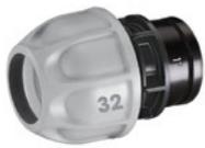
Kupplung aus PP für die Verbindung eines PE-Rohres 1" (Ø 32 mm) an einen Wasseranschluss oder an ein Magnetventil (CL908130000 oder CL908150000) mit AG 1"
