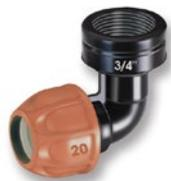
Winkelstück aus PP für den Anschluss einer Gewindeverlängerung oder eines Ablassventils mit Außengewinde 3/4" am Leitungsende eines 20 mm-PE-Rohres
