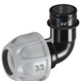
Winkelstück aus PP für den Anschluss einer Gewindeverlängerung oder eines Ablassventils mit AG 3/4" am Leitungsende eines PE-Rohres 1" (Ø 32 mm)
