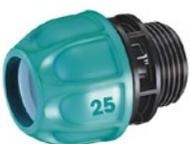
Kupplung aus PP für die Verbindung eines PE-Rohres 3/4" (Ø 25 mm) mit einem Wasseranschluss oder einem Magnetventil (CL908120000 oder CL908140000) mit IG 1"
