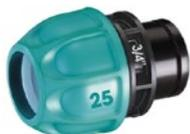
Kupplung aus PP für die Verbindung eines PE-Rohres 3/4" (Ø 25 mm) mit einem Wasseranschluss oder einem Magnetventil mit AG 3/4".
