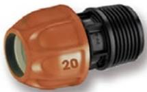
Kupplung aus PP zum Verbinden eines 20 mm-PE-Rohres mit einem Wasseranschluss oder einem Magnetventil (CL908120000 oder CL908140000) mit 1" IG
