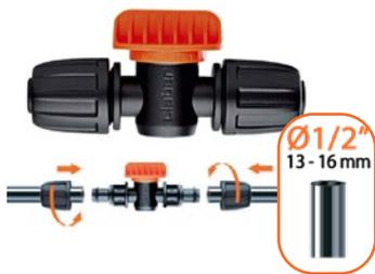
Zum Regulieren, Öffnen und Schließen des Wasserflusses einer Leitung. Wird zwischen zwei Abschnitten eines Verteilerrohres 1/2" (13 - 16 mm) montiert. Korpus: PP
