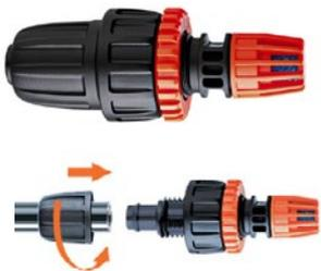
Zum automatischen Entleeren der Verteilerrohre 1/2" (13-16 mm) eines Tropfbewässerungskreises. Besonders hilfreich für Gebiete mit kalten Wintern. Entleert automatisch die Anlage nach der Verwendung und schützt sie damit auch in besonders harten Wintern vor Frostschäden. Korpus: PP
