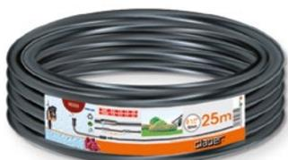
Biegsames PE-Tropfrohr 1/2" (13 – 16 mm) mit integrierten, labyrinthartig angeordneten Tropfern (alle 33 cm) für die effiziente Bewässerung von Blumen- und Gemüsebeeten. Die integrierten Tropfer benetzen den Boden in der Nähe der Wurzeln und geben jeweils 2 l/h an den Boden ab. Dadurch wird eine extrem gleichmäßige Bewässerung auf der gesamten Fläche gewährleistet (bei Betriebsdruck zwischen 0,5 und 1 bar geringerer Wasserverbrauch). Farbe: Schwarz
