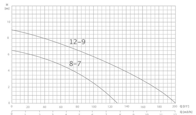
Diese Übersicht basiert auf einer kinematischen Viskosität von 1mm<sup>2</sup>/s und einer Dichte von 1.000kg/m<sup>3</sup>.
